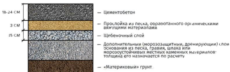
Рис. 2. Графический образец разреза цементобетонного покрытия
