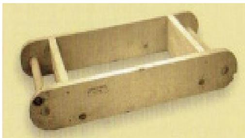
Рис. 6. Деревянная форма для изготовления самана
