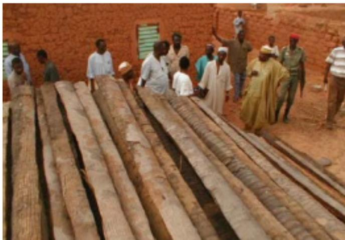
Рис. 5. Древесина ронье для кровли
